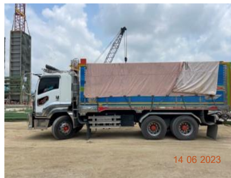
ภาพที่ 2-3 ผ้าใบปิดคลุมท้ายรถบรรทุก ในการขนส่งวัสดุก่อสร้าง
